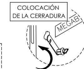
(E) SE EMPLEA PARA MODELOS DE VARIAS PUERTAS POR TAQUILLA PARA LOS TAPES INTERMEDIOS; SIRVIENDO ASÍ DE PIVOTE SUPERIOR PARA LA PUERTA DE ABAJO Y DE PIVOTE INFERIOR PARA LA DE ARRIBA
